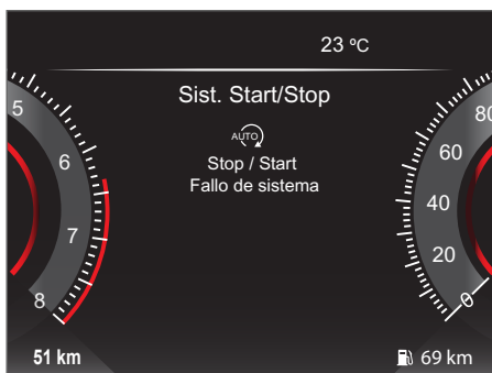
Falla del sistema Start/Stop
