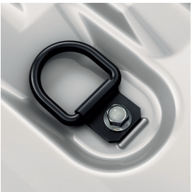
6 gólfkastar D-bindilykkjur halda allt að 509 kg.
