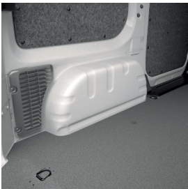
Sléttar hjólaskálar auðvelda uppstöflun í hleðslurými.
