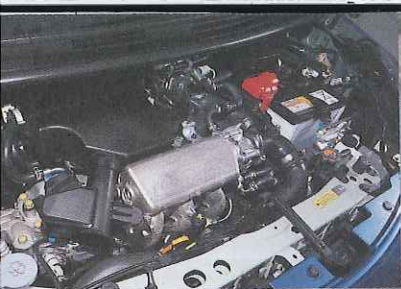
▲1.2公升直三supercharged引擎得98匹馬力唔算特別勁，但低扭出色，起步加速比1.5公升自然吸氣引擎有過之而無不及。
