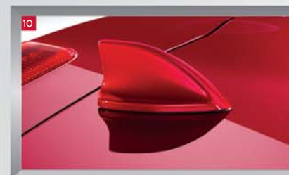
Antenne aileron de requin non compatible avec la diffusion audionumérique (DAB)
