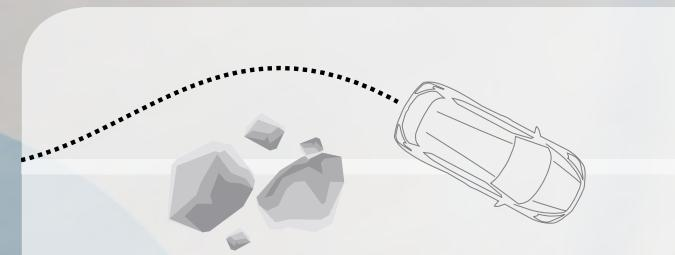
**Vehicle Dynamic Control** (Control Dinámico del Vehículo) te ayuda a mantenerte en la dirección que quieras ir. Monitorea tu forma de manejar y frenar y la compara con el trayecto del vehículo. Despues reduce la potencia del motor y/o aplica los frenos en ciertas ruedas para ayudarte a mantenerte en tu camino.
