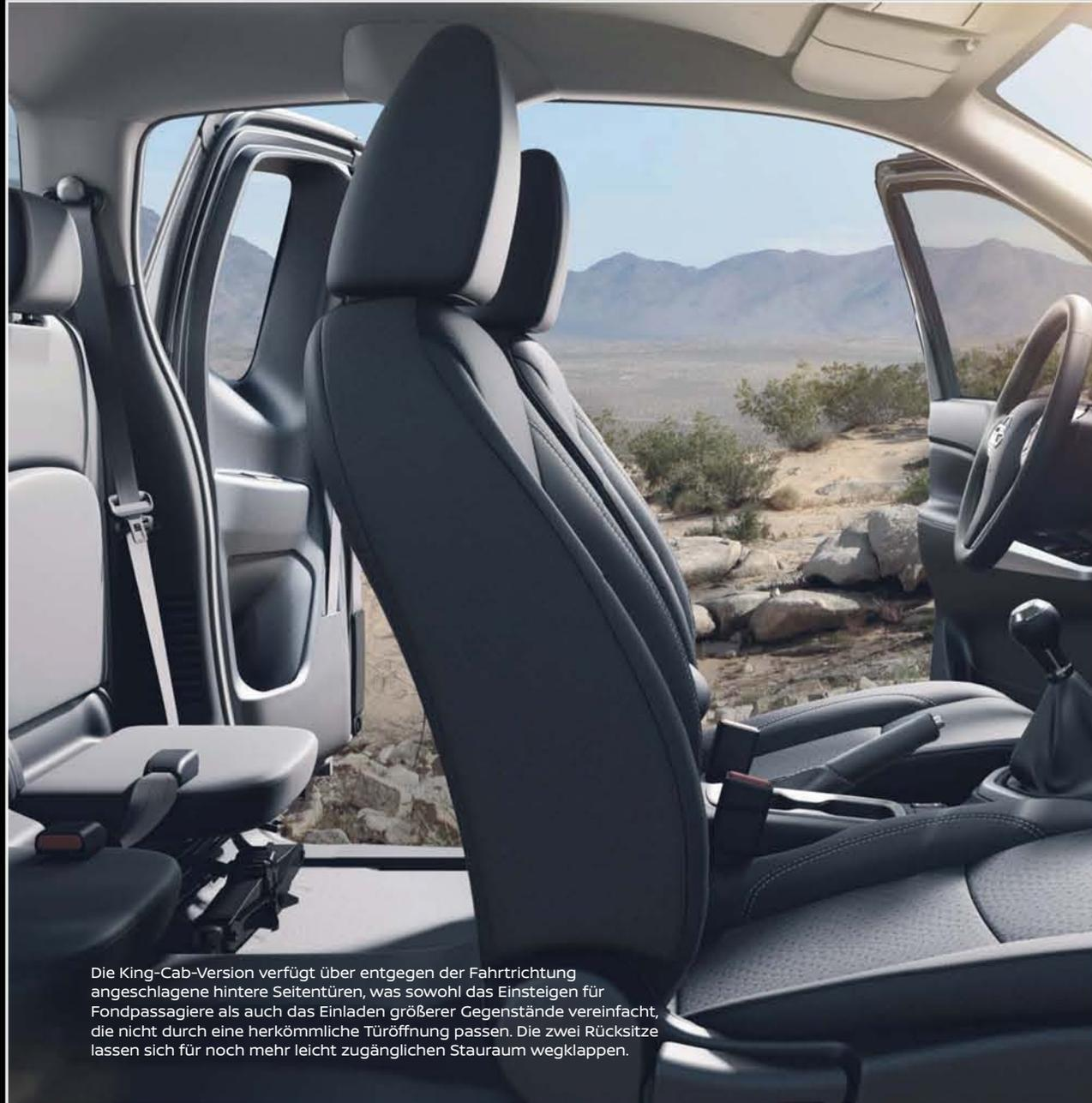
Die King-Cab-Version verfügt über entgegen der Fahrtrichtung angeschlagene hintere Seitentüren, was sowohl das Einsteigen für Fondpassagiere als auch das Einladen größerer Gegenstände vereinfacht, die nicht durch eine herkömmliche Türöffnung passen. Die zwei Rücksitze lassen sich für noch mehr leicht zugänglichen Stauraum wegklappen.
