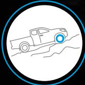
El Asistente de Arranque en Pendientes (HSA) mantiene a el vehículo frenado aproximadamente durante 3 segundos sobre una cuesta; permitiendole al conductor retirar el pie del freno y acelerar tranquilamente sin que este se desplace hacia atrás.
