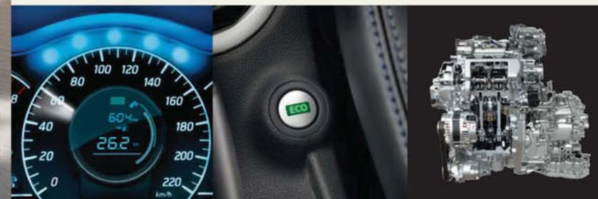
**ÉCOMÈTRE.** Deux nouveaux indicateurs font leur apparition sur l'affichage ultralisible, en HD et en couleur, du tableau de bord. L'éco-pédale renseigne le conducteur sur son niveau d'éco-conduite en fonction du style de conduite et de la pression exercée sur l'accélérateur, tandis que l'écomètre constitue un guide visuel de la consommation globale réalisée sur chaque trajet en temps réel. Mettez-vous au vert !
