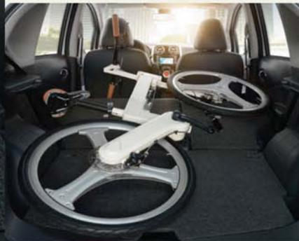
**SIÈGES RABATTABLES.** Un levier permet de rabattre les sièges vers l'avant (60:40) pour dégager du coffre. Si vous avancez le siège passager au maximum, vous pourrez charger de longs objets jusqu'à 1.70 m.
