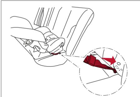
Sujeción tipo gancho del enganche orientado hacia atrás - paso 2
