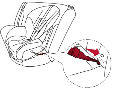
**Sujeción tipo gancho del enganche orientado hacia delante - paso 2**
