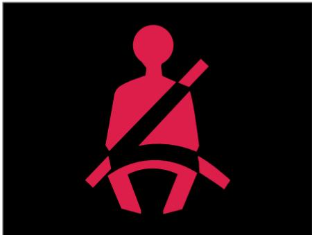
La luz de aviso del cinturón de seguridad va a destellar, según las condiciones descritas anteriormente hasta que el cinturón de seguridad correspondiente sea correctamente abrochado. Un aviso sonoro se va a emitir por cerca de 95 segundos o hasta que una de las condiciones a continuación se cumpla:
