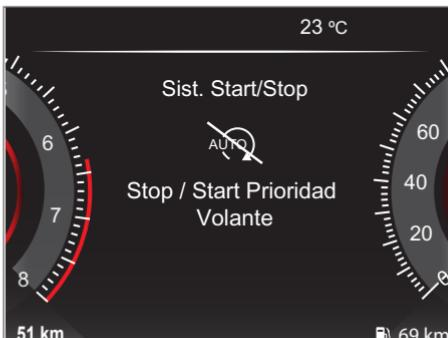
Orientación Start/Stop (detección de operación del volante de dirección)
