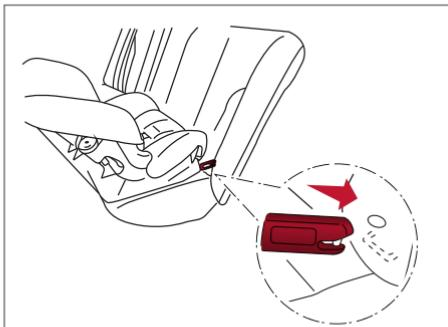
Orientado hacia atrás tipo gancho rígido – paso 2
