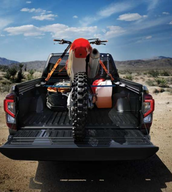
El Sistema Utility-Track es ideal para asegurar hasta la carga más pesada. El sistema consta de dos canales a lo largo de la caja del pickup y cuatro resistentes ganchos de carga que te permiten colocar puntos de amarre estables prácticamente en cualquier lugar.
