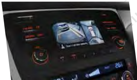
MONITOR INTELIGENTE DE VISIÓN PERIFÉRICA 360° (AVM) CON DETECCIÓN DE OBJETOS EN MOVIMIENTO
